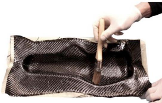
In alcuni punti (sotto scalini e sottosquadra) si possono verificare degli accumuli di resina, per questo consigliamo di rimuoverla tramite una spatola morbida. Se vengono usati pennelli di scarsa qualità, a contatto con la resina, potrebbero perdere alcune setole che sono da rimuovere tassativamente a resina non ancora indurita.
